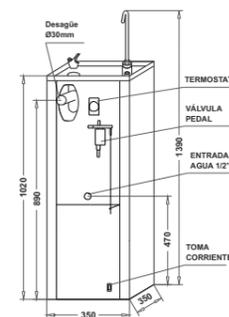
Instalación mediante tres puntos de conexión básicos.
