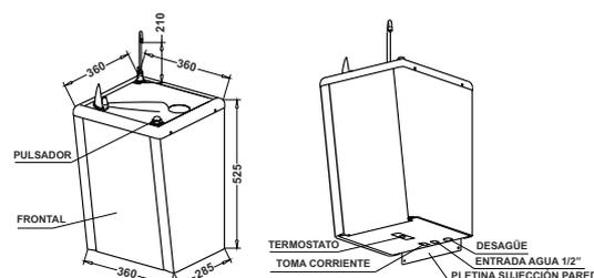
Instalación mediante tres puntos de conexión básicos.
