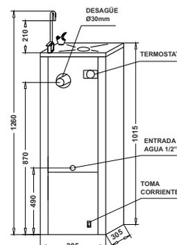
Instalación mediante tres puntos de conexión básicos.
